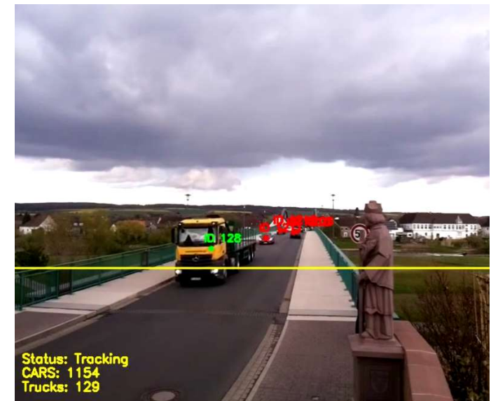
Beispiel: Verkehrsdatenerhebung mit automatisierter Sortierung an Messstelle 3
